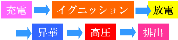
電熱加速型PPTの作動原理
