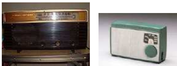
図 34 当時の真空管ラジオと日本最初のトランジスタラジオ「TR-55」 16 (1955年)
