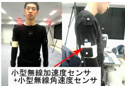
図2 モーションキャプチャシステムと無線小型センサの取り付け位置
