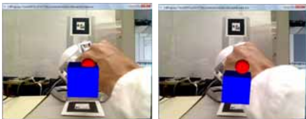
図7 カメラ2台によるオクルージョンの回避 (左:カメラ1でマーカ検出,右:カメラ2でマーカ検出)
