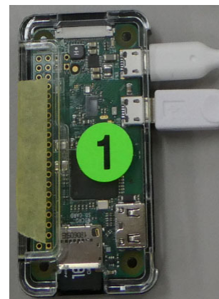
図3 Tag からの電波を受信するために用いたマイコン Raspberry Pi Zero W が入ったモジュール
