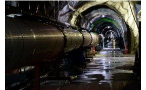
重力波観測装置KAGRA：岐阜県神岡鉱山跡地に作られた一辺3kmのレーザー干渉計で、重力波を捕らえる準備が進められています。
