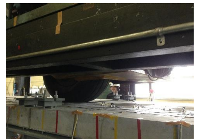
RC床版の輪荷重走行試験
