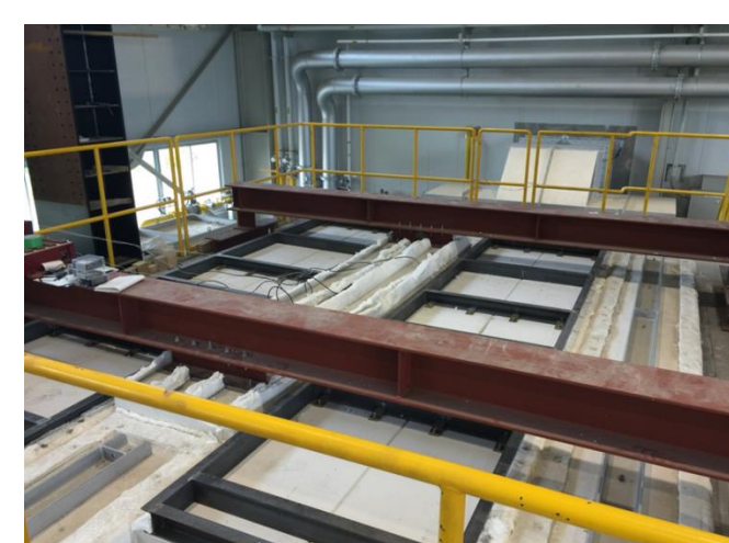
プレテンションPC桁の加熱試験
