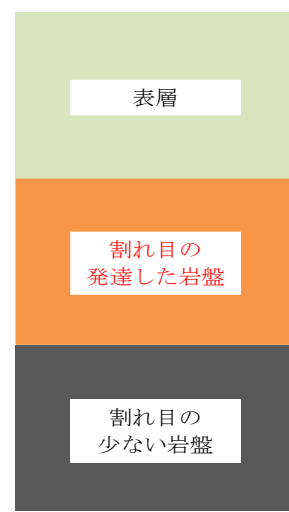
図3 A-Hタンクモデルによる深層崩壊危険度予測の概念
