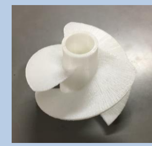
3Dプリンターで試作したポンプインデューサー
