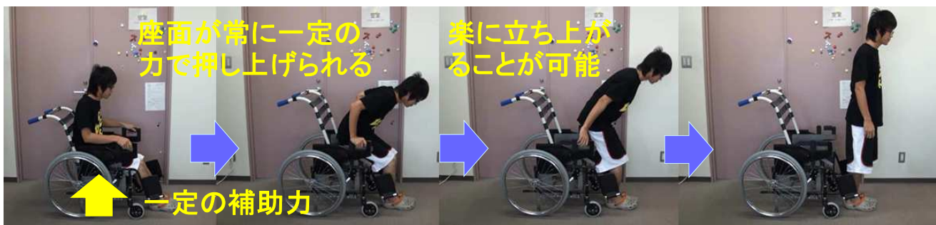
図1 動力なしで立ち上がり・移乗を補助する車いす
