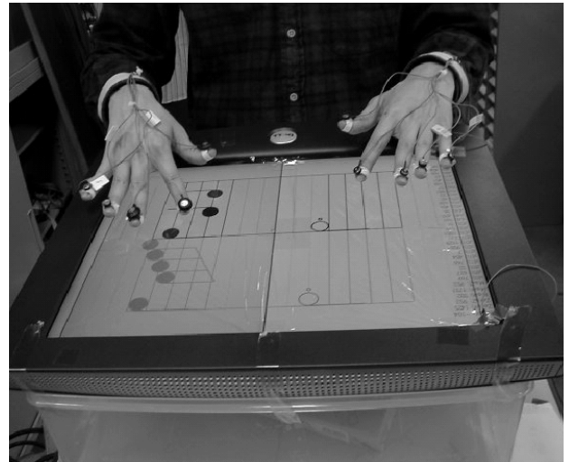
図12 光学的3次元計測利用のCymis Fig.12 3D optical detection type Cymis
