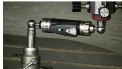
図3 RENISHAW 製 QC20-W ボールバーシステム
