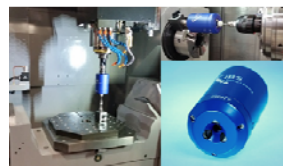
図 1 非接触式 R-test 装置
