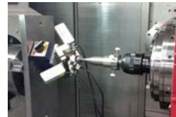
図 2 自作 R-test 装置
