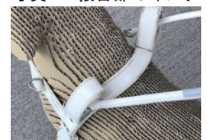
写真 3 接合部の外れ
