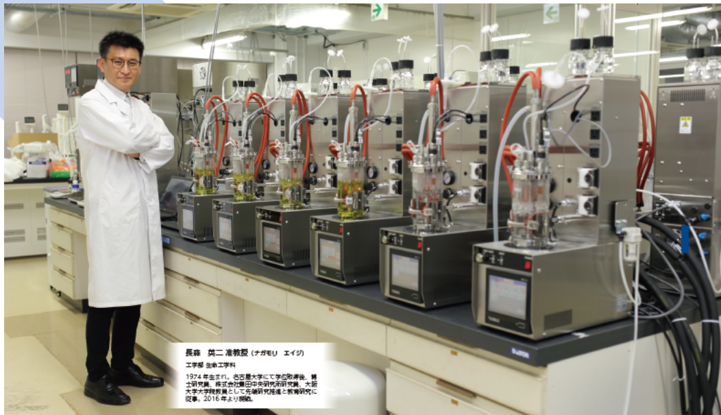
Bio Jr.B 100mL x 6 連続培養装置 温度、pH、溶気、射ガスで制御しながら培養するための機器 (実際には24連で使用)
