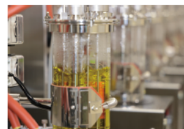
微生物培養装置 BMZ-F 温度、溶気、pH、DO、溶気、溶液の制御が可能で容易に培養が行える装置
