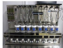
Bio Jr.B 100mL x 6 連続培養装置 温度、pH、溶気、射ガスで制御しながら培養するための機器 (実際には24連で使用)
