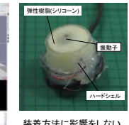
装着方法に影響をしない弾性樹脂を用いた振動子の装着方法の研究 (pp. 39)
