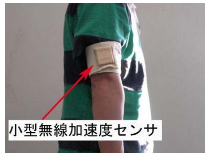
小型無線加速度センサによる 上腕関節可動域の測定手法
