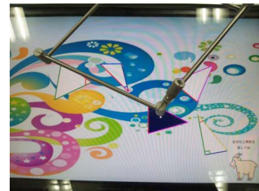
図形問題の学習を目的とした力覚提示システムの研究
