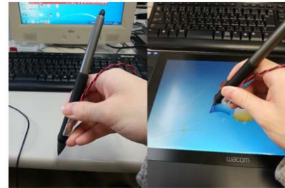
ペンタブレットと記録再生型触覚提示装置を組み合わせた触覚提示
