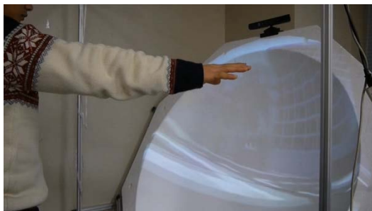
球面型スクリーンを用いた上肢での視点移動操作におけるVR空間の探索
