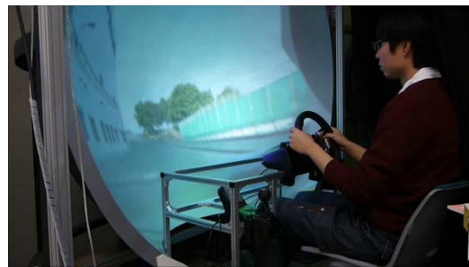
没入型ディスプレイと車載映像による自動車運転の危険予測
