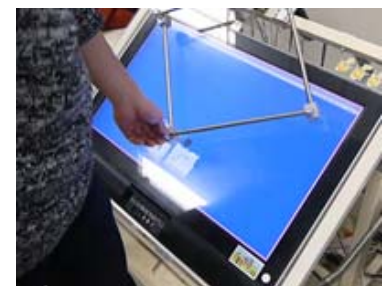
平面型力覚提示装置を使った 深度カメラ映像の可触化
