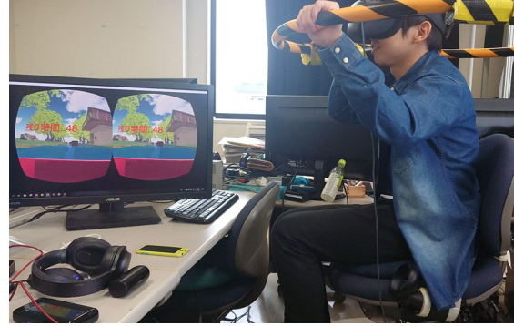
揺動感覚を生成する 着座型重心移動インタフェース
