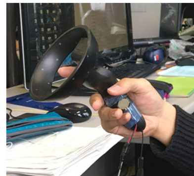
把持力に応じた遅延量変化による 疑似力覚提示手法の開発
