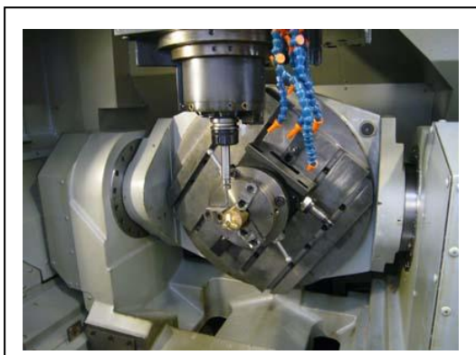
5 軸マシニングセンタ、加工の様子
