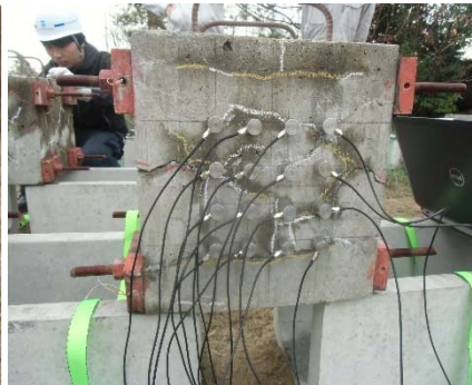
写真-2 超音波測定
