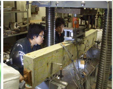
写真-3 載荷試験
