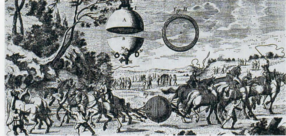
ドイツのゲーリケ（当時のマグデブルグ市長）が17世紀半ばに行った大気圧の大きさを示す実験。2つの金属製半球容器を合わせて中の空気を抜くと、ぴったりくっついて外れなくなった。両側から馬8頭ずつで双方から引っ張ってもなかなか外れない様子が描かれている。（ちなみに、作用反作用の法則により、片側を固定して馬8頭で引っ張っても同じである。）
