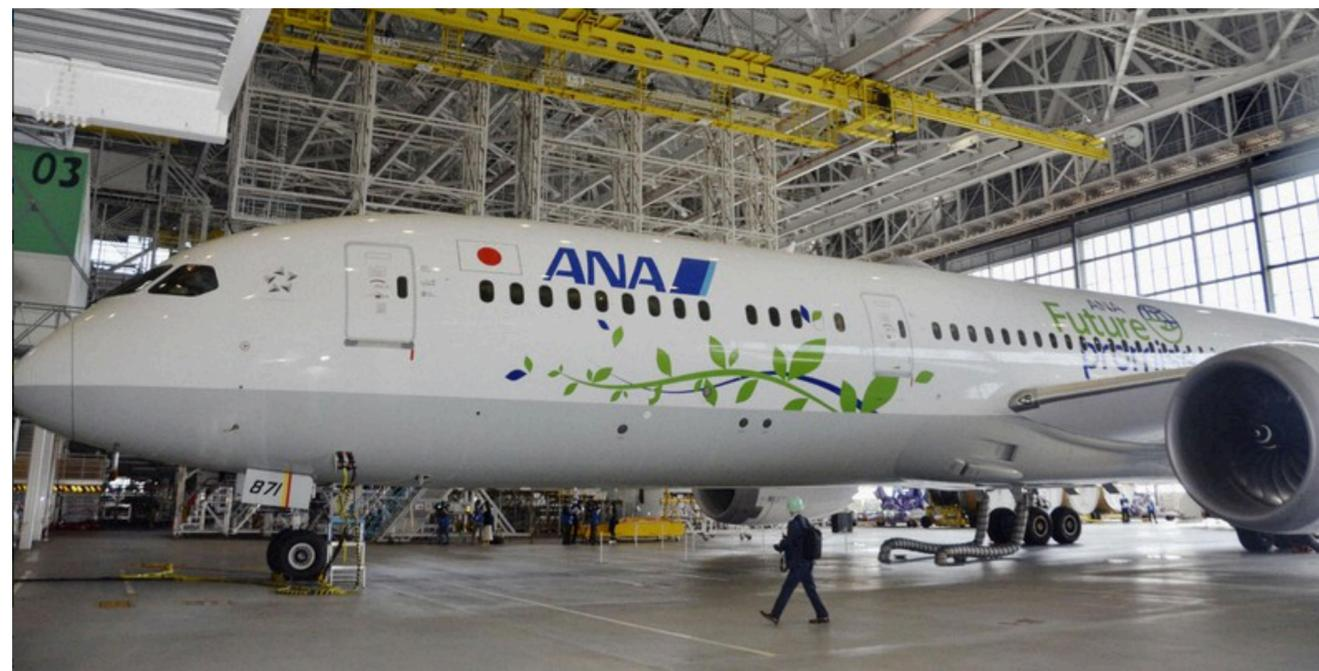
全日本空輸は、環境に配慮した新しい機体を東京都内で公開した。機体表面に空気抵抗を減らす「サメ肌」状の特殊なフィルムを貼ることで燃費を向上させ、二酸化炭素（CO2）削減につなげる。今後、運航を通じて効果を検証し、将来的に全ての機体への導入を目指す。
