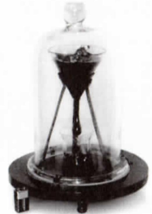
図 3.22 クィーンズランド大学のピッチドロップ実験
