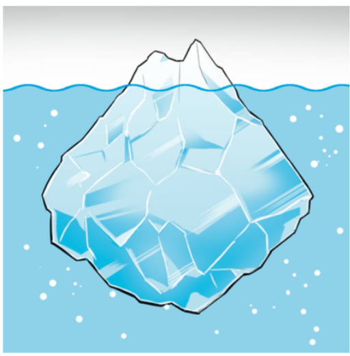
流体の重さの分だけ 下からの圧力が大きい
