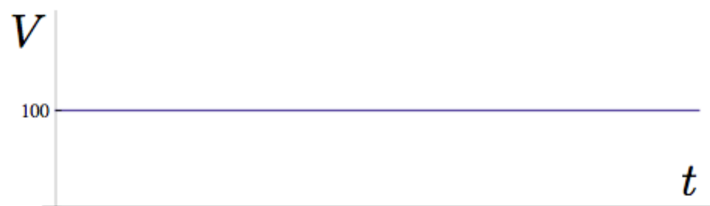
図 15: 〔左〕 直流電源からの起電力 V(t) は常に一定. 〔右〕 交流電源からの起電力 V(t) = V_0 \sin(2\pi ft) . \bar{V} = 100 \text{ V} の起電力は, 最大 V_0 = 100\sqrt{2} = 141 \text{ V} になる. f = 60 \text{ Hz} は, 1 秒間に 60 回振動することを表す.
