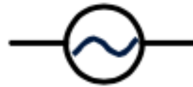
図 14: 交流電源 (AC; alternating current)
