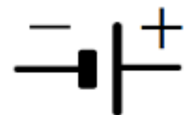
図 13: 直流電源 (DC; direct current)
