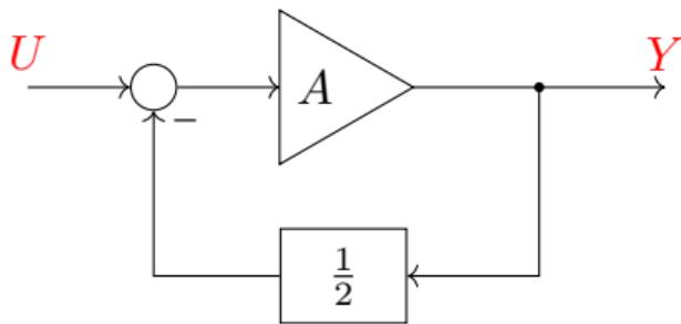
図において、 $A = \frac{0.002 \times j\omega}{0.001 \times j\omega + 1}$  である。
