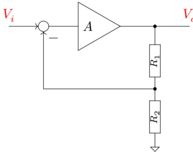
左図のように電位を A 倍する増幅器の出力を 2 つの抵抗器で分圧して負帰還した。
