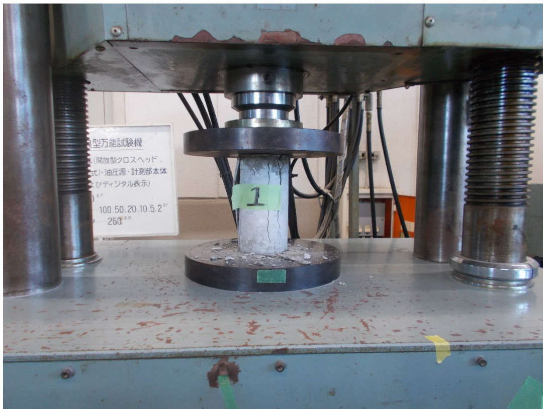
写真-1 載荷試験の様子
