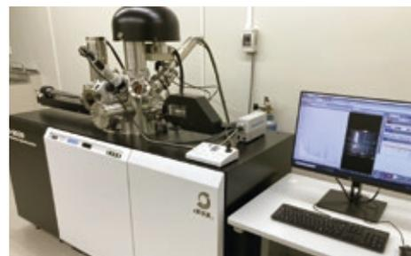
新しく導入されたX線光電子分光装置(XPS)
