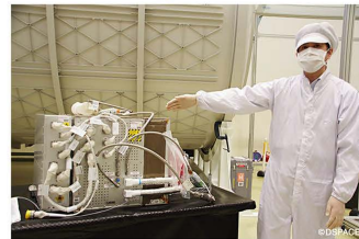
宇宙ステーションでの尿・汗の循環装置(三菱電機)
